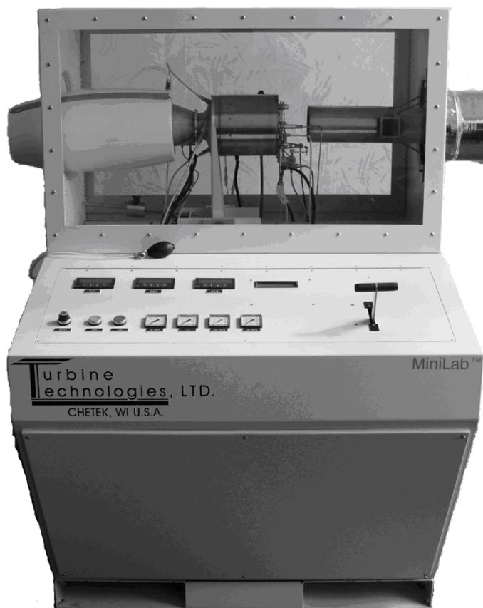
**Рис. 1.** Газотурбинная установка на базе двигателя SR-30
