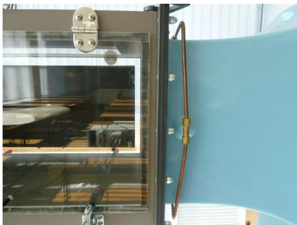
**Рис. 4.** Коллектор приемников статического давления на входе в камеру визуализации
