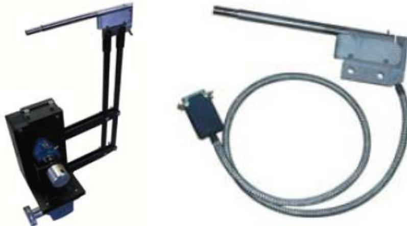
**Рис. 2.** Система позиционирования и стержневые тензovesы аэродинамической трубы
