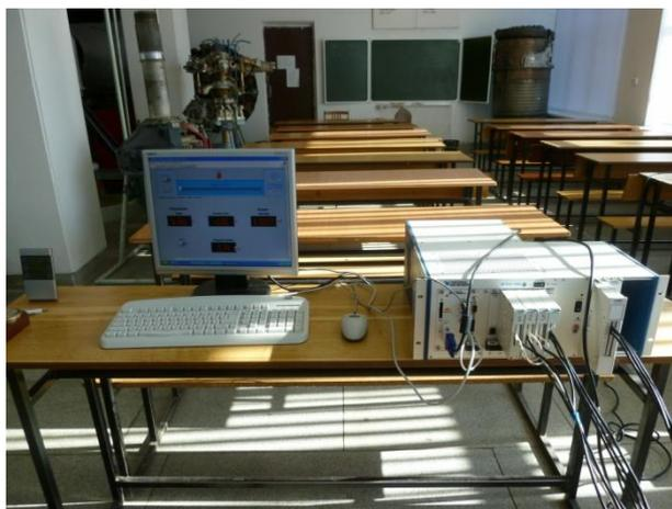
**Рис. 6.** Рабочая станция National Instruments с программным обеспечением LabView 8.6
