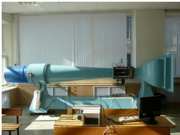
Рис. 1. Внешний вид аэродинамической трубы Aerolab EWT
