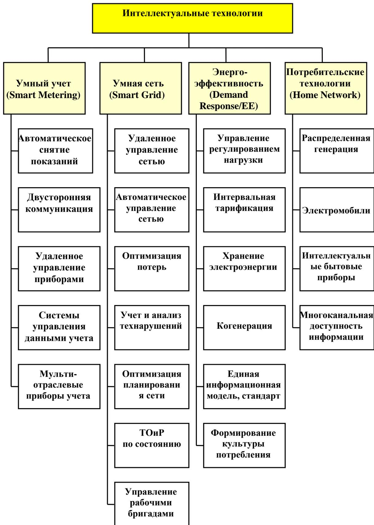
Рис. 2. Структура технологического базиса концепции Smart Grid
