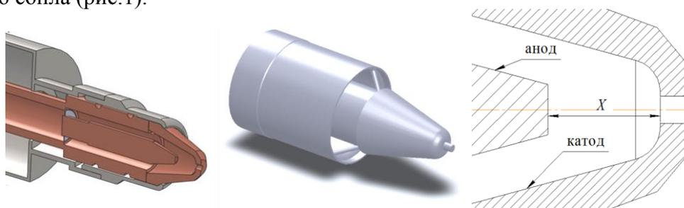
**Рис. 1.** Твердотельная модель ЭГДП в разрезе и проточная часть устройства.
