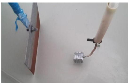
**Рис.3.** Расположение образцов в электролитической ванне
