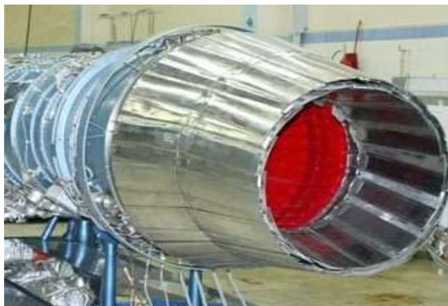
Рис. 2. Сопло двигателя АЛ-31Ф
