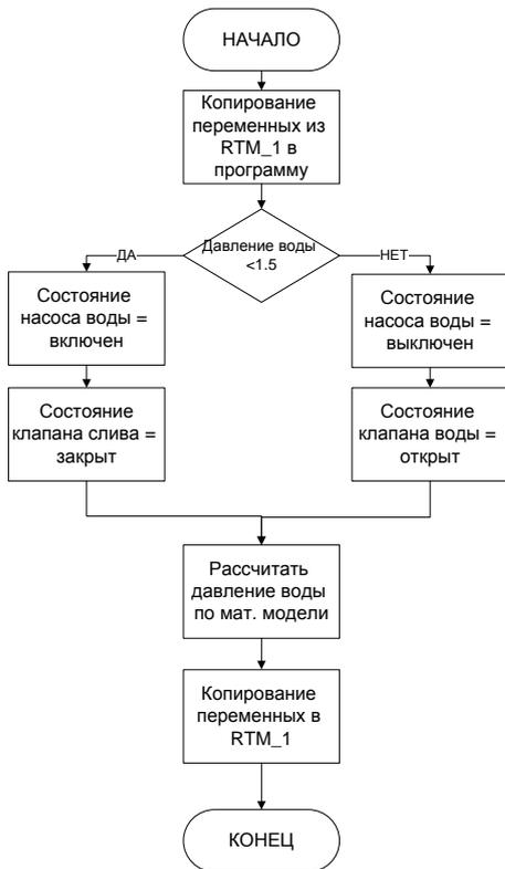
Рис.7. Алгоритм программы подачи охлаждающей жидкости
