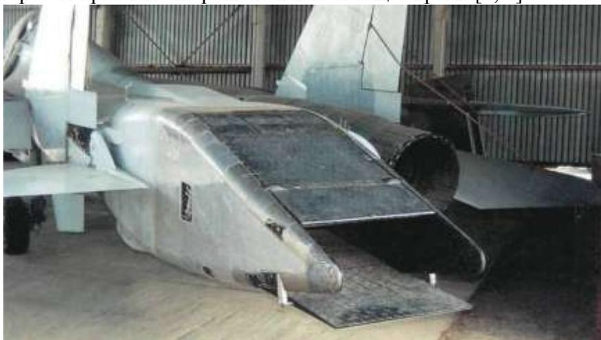
Рис. 9. Опытный образец АЛ-31Ф с плоским соплом
