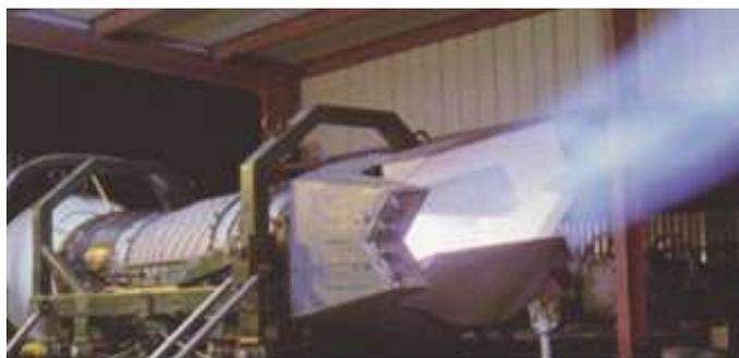
Рис. 7. Сопло двигателя Pratt&Whitney F119 PW100
