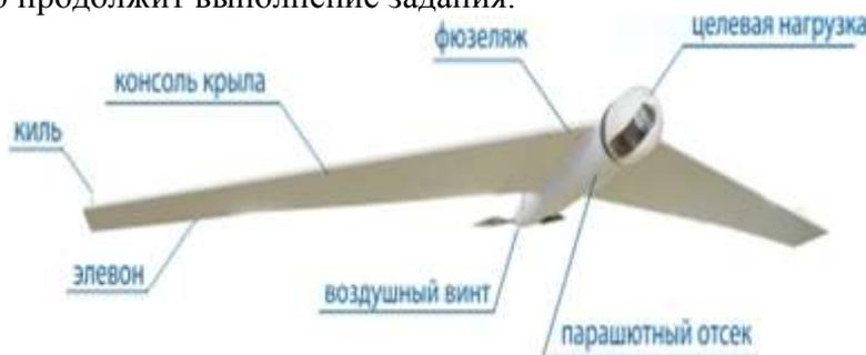
Рис. 1. БПЛА ZALA 421-16E
