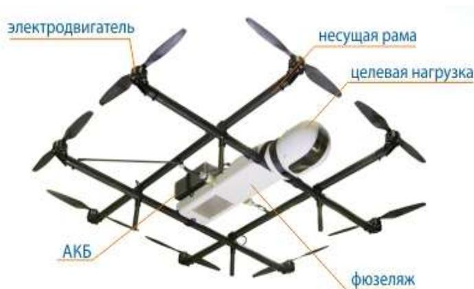
Рис. 3. БПЛА ZALA 421-22
