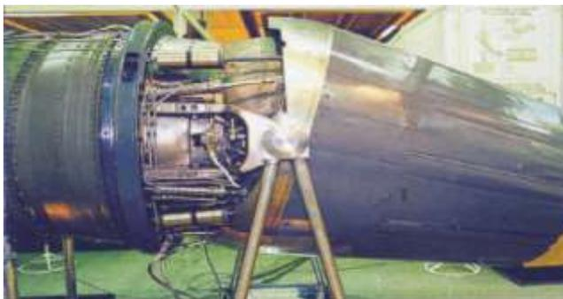
**Рис. 10.** Сопло двигателя АЛ-31ФП с поворотным осесимметричным сверхзвуковым реактивным соплом
