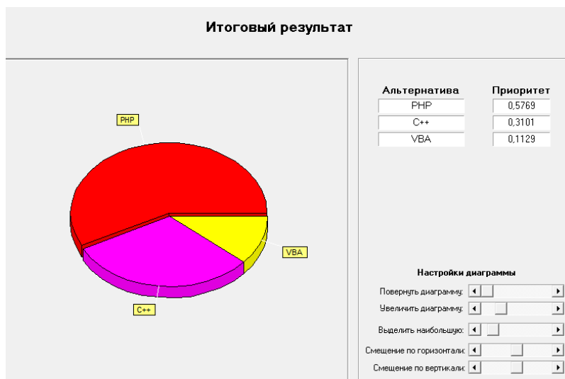
Рис. 7. Результат выбора технологии реализации методом анализа иерархий
