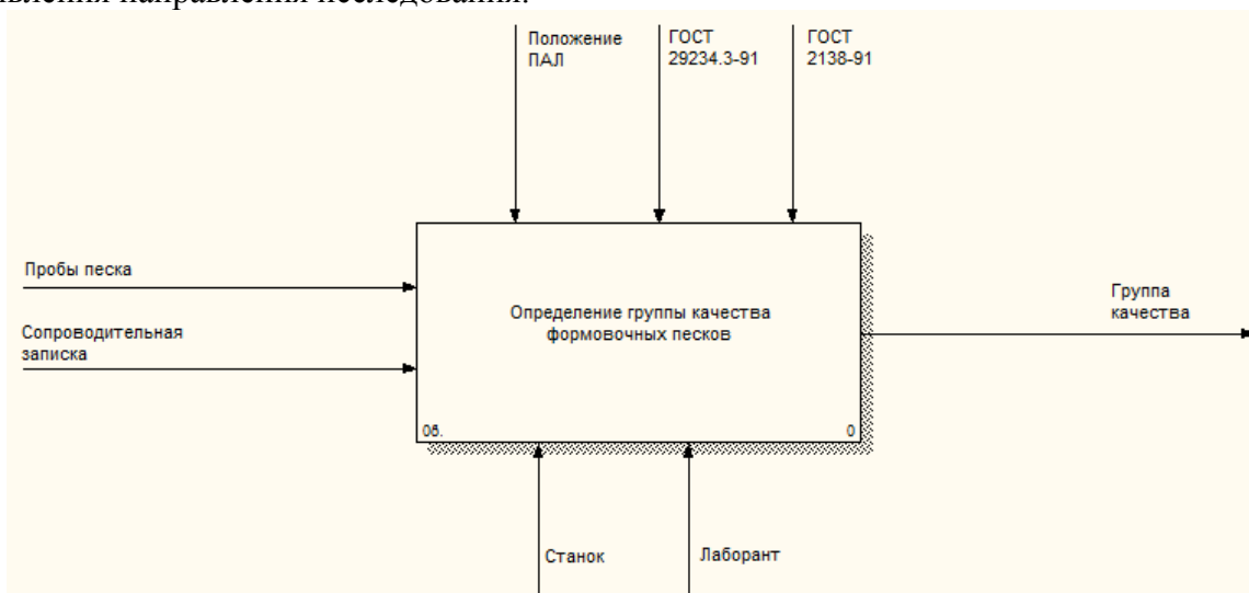
Рис.2. Функциональная модель «Определение группы качества формовочных песков», уровень А0 «КАК ЕСТЬ»
