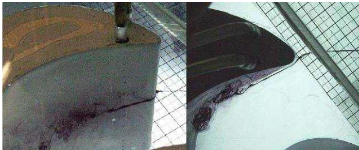
Рис. 5. Отрыв потока на корытце лопатки турбины
