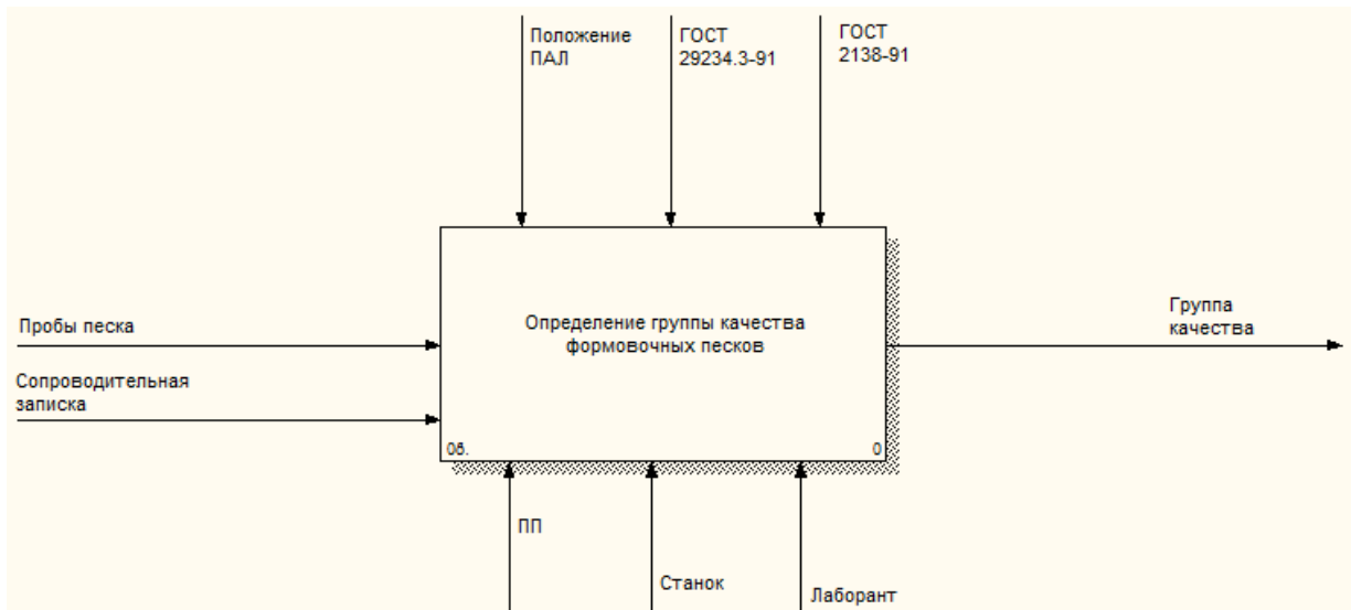
Рис. 6. Функциональная модель «Определение группы качества формовочных песков», уровень А0 «КАК ДОЛЖНО БЫТЬ»
