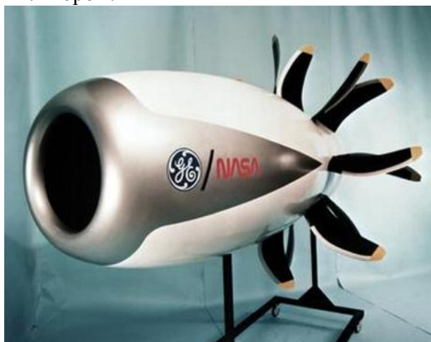
Рис. 7. Двигатель GE 36( фотография с сайта Wikipedia.com)
