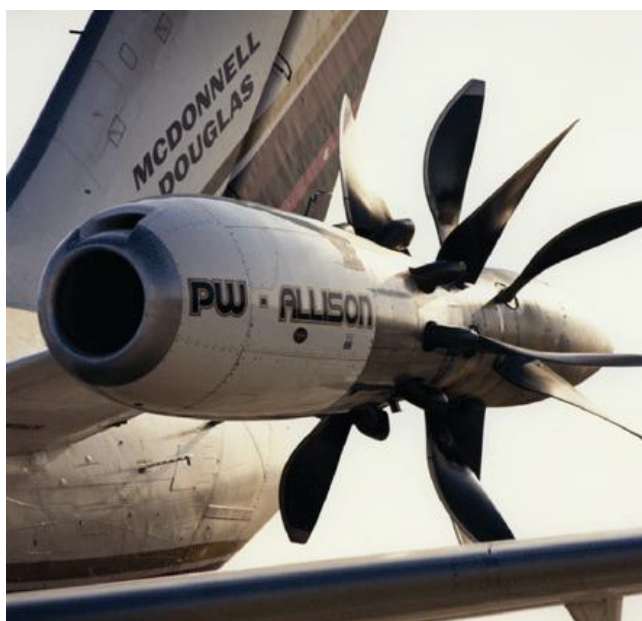
Рис. 8. Двигатель 578-DX (фотография с сайта ato.ru)
