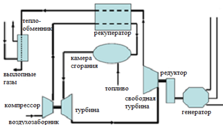
Рис. 5. Схема установки Ingersoll 70
