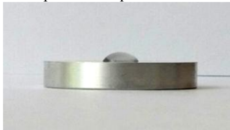
Рис. 10. Капля дистиллированной воды на образце с Ra(1)=0,291
