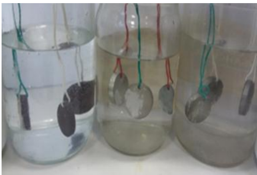
Рис. 2 – Образцы во время выдержки в коррозионно-агрессивном растворе
