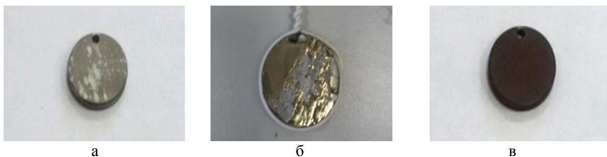
Рис. 3 – Образцы после испытаний на коррозионную стойкость: а – TiN, нанесенный ИИ; б – TiN, нанесенный плазменным напылением; в – МДО
