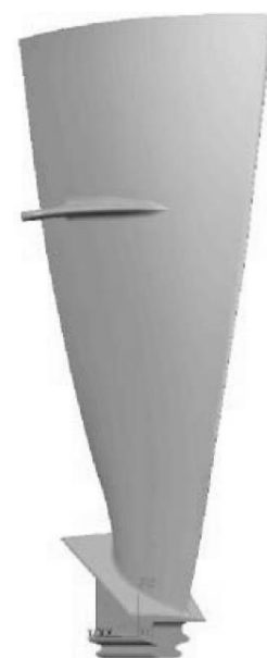
Рис. 3. 3-D твердотельная модель лопатки вентилятора ПС-90А
