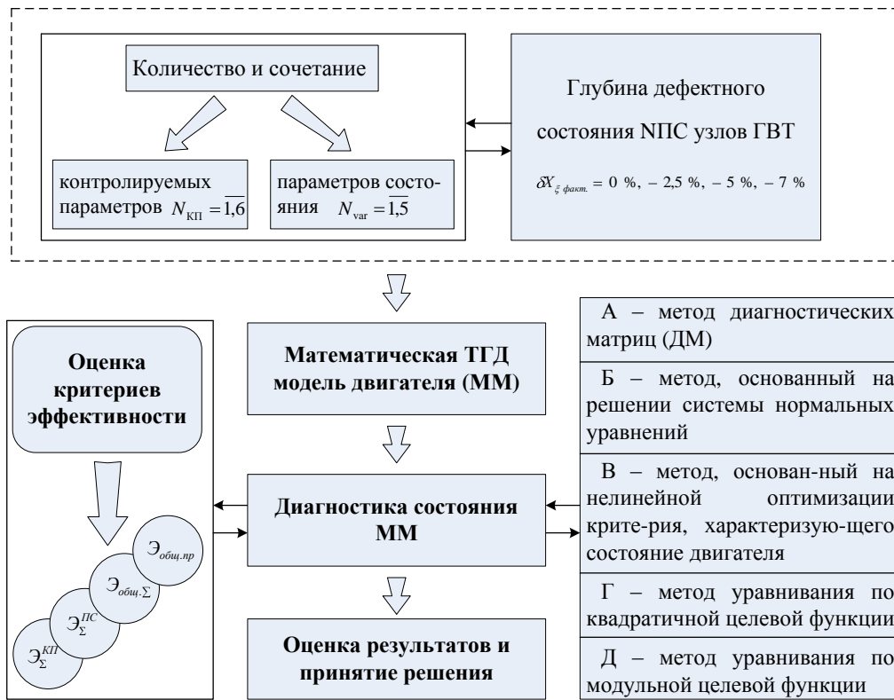
Рис. 2. Схема сравнительной оценки эффективности методов диагностики состояния ГТД
