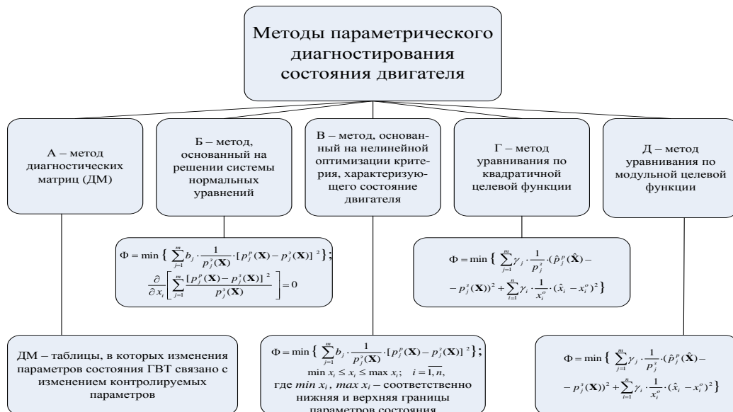
Рис. 1. Методы параметрического диагностирования состояния двигателя: \Phi – целевая функция; p_j^p(X) – оценка j -го контролируемого параметра по математической модели
