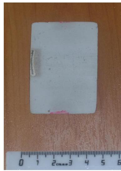
**Рис. 2.** Образец лопатки ГТД с МДО-слоем
