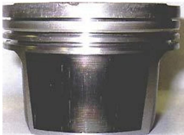
**Рис. 1** Износ антифрикционного покрытия Molykote-D10 [11]
