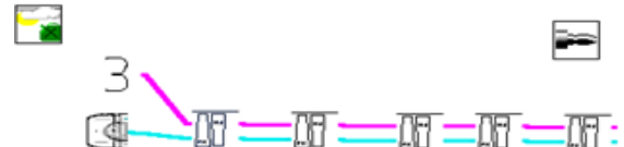
Рис. 23. Топологическая модель пятиступенчатого осевого компрессора в СИМ STUPENY
