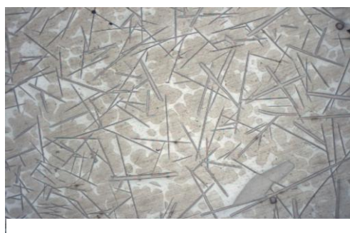
Рис.1. Структура лигатуры системы Al–Cr–V для образца №4: а – (x100); б – (x1000)
