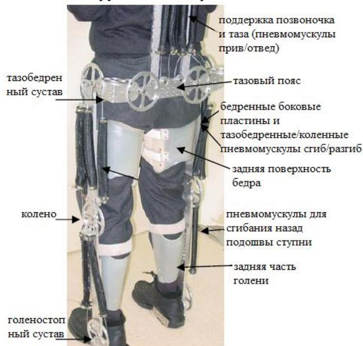
**Рис. 5.** Компоновочная схема экзоскелета с *pMAs*
