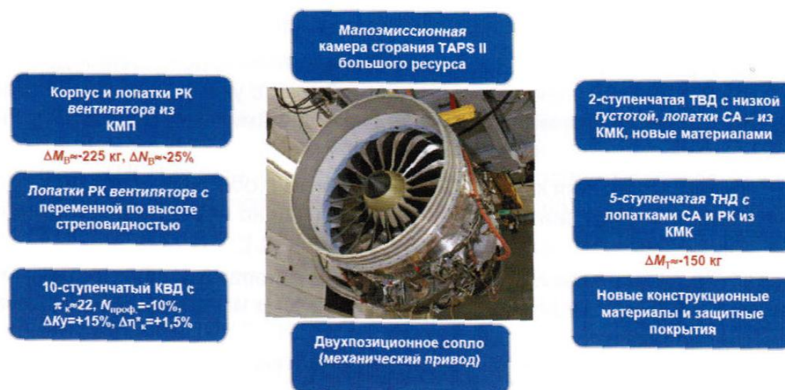
Рис. 2. Конструктивные особенности ТРДД LEAP-X
