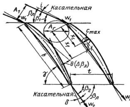
Рис. 1. Схема и геометрические параметры компрессорной решетки
